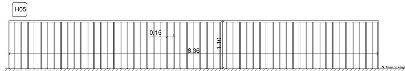
BASTIDOR HORIZONTAL 30X30X1,6mm
