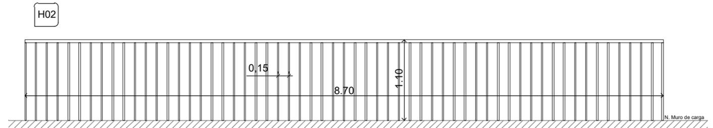
BASTIDOR HORIZONTAL 30X30X1,6mm
