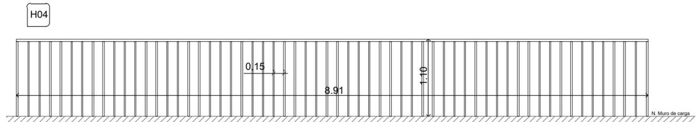
BASTIDOR HORIZONTAL 30X30X1,6mm
