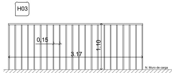
BASTIDOR HORIZONTAL 30X30X1,6mm
