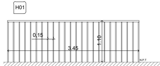
BASTIDOR HORIZONTAL 30X30X1,6mm
