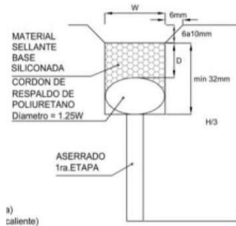
Gráfico 1. Esquema del tomado de junta.
