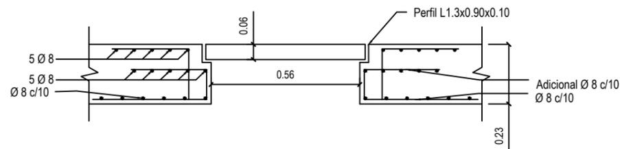
DETALLE DE TAPA - ARMADO DEL ORIFICIO
