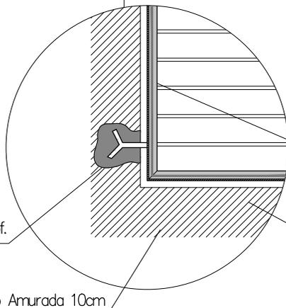
Amurado de concreto impermeable 1:3 10% Hidrof.
