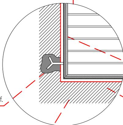
Amurado de concreto impermeable 1:3 10% Hidrof.
