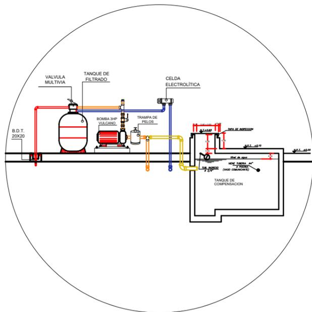
ESQUEMA SISTEMA CLORACIÓN SALINA
