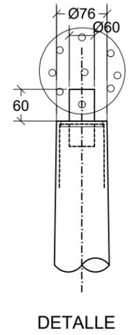
TUBO DE REFUERZO DE 4 mm. DE ESPESOR
