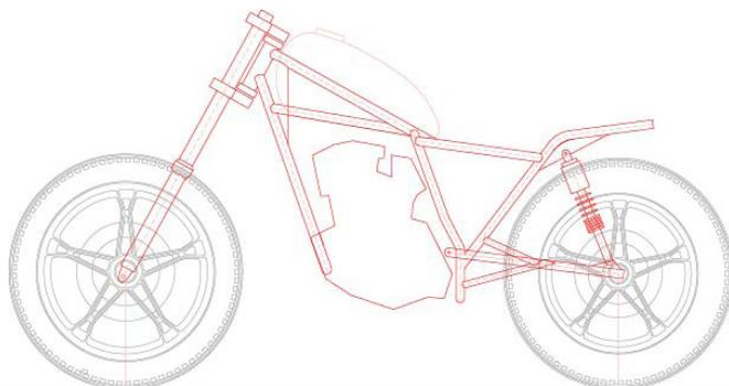
La suspensión trasera consta de resortes en espiral y amortiguadores telescópicos. Los amortiguadores trabajan generalmente con aceite. La suspensión trasera puede regularse al peso del conductor y debe realizarse según la especificación del fabricante en un taller especializado para evitar dañar el sistema de amortiguación.
