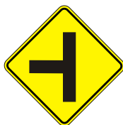
Encrucijada (Empalme) P 24
