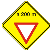
Proximidad de Señal Restrictiva (Paso) P 33
