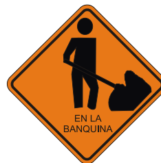
Trabajos en la Banquina T 8
